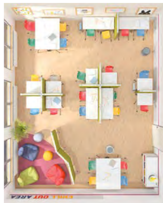
Cubierto de tela, tabique acústico móvil paredes de 140 cm de alto permite trabajar en silencio sin perjudicar la visión general del aula.
